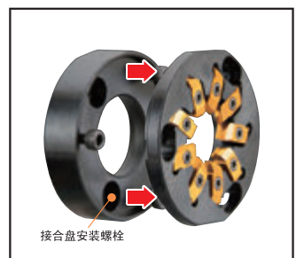
拔出刀片交换刀盘 (不需要拆卸螺栓)
