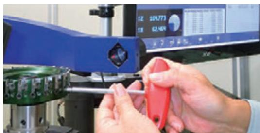
顺时针旋转其中一个刀尖高度调整螺丝，直到螺丝位置和刀盘本体外缘持平(参考刀尖高度：44.990mm)。以此刀尖高度为基准，调节其他刀尖高度(调节至10um以内)。
