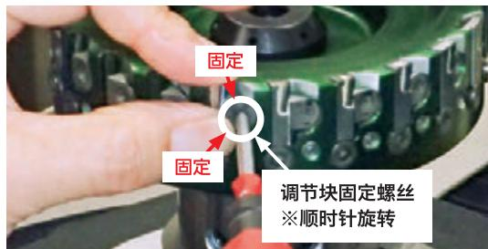
放入刀片。向刀盘中心方向，按住刀片的上面和下侧面的同时，以1N·m的力拧紧调节块固定螺丝。
