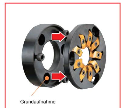
Entnehmen Sie nur den Wendeplattenhalter zum Wechsel der Einsätze. Es ist nicht nötig, die Grundaufnahme aus der Maschine zu entfernen
