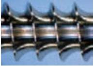
シングルポイント加工 Single-point Threading
