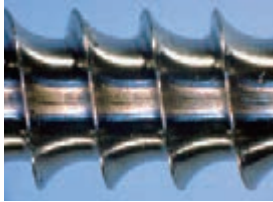
NTKスレッドワーリング NTK Thread Whirling
