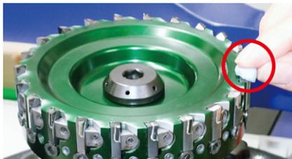
ゴミによる精度のズレを防ぐ為、粘土などで刃先を掃除する。
