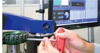
アキシタル調整ネジをボディ外周から飛び出ない位置付近まで回す。（時計回り）【刃先の目安高さ44.980mm】その高さに合わせて、全刃高さを合わせる。（10 $\mu$ m以内程度）
