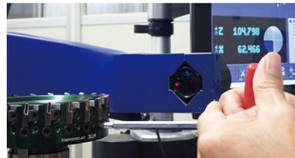
アキシタル調整ネジを回し、更に全刃10 $\mu$ mアップさせ刃先高さが $\pm 2\mu$ m以内に収まるように調整する。【刃先の目安高さ45.000mm】
