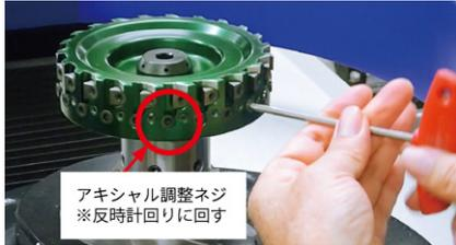
アキシタル調整ネジを緩め、ボディ外周より1~2mm程度外に出す。再セット時はインサート取り外し後、インサート取付け部をエア清掃する。
