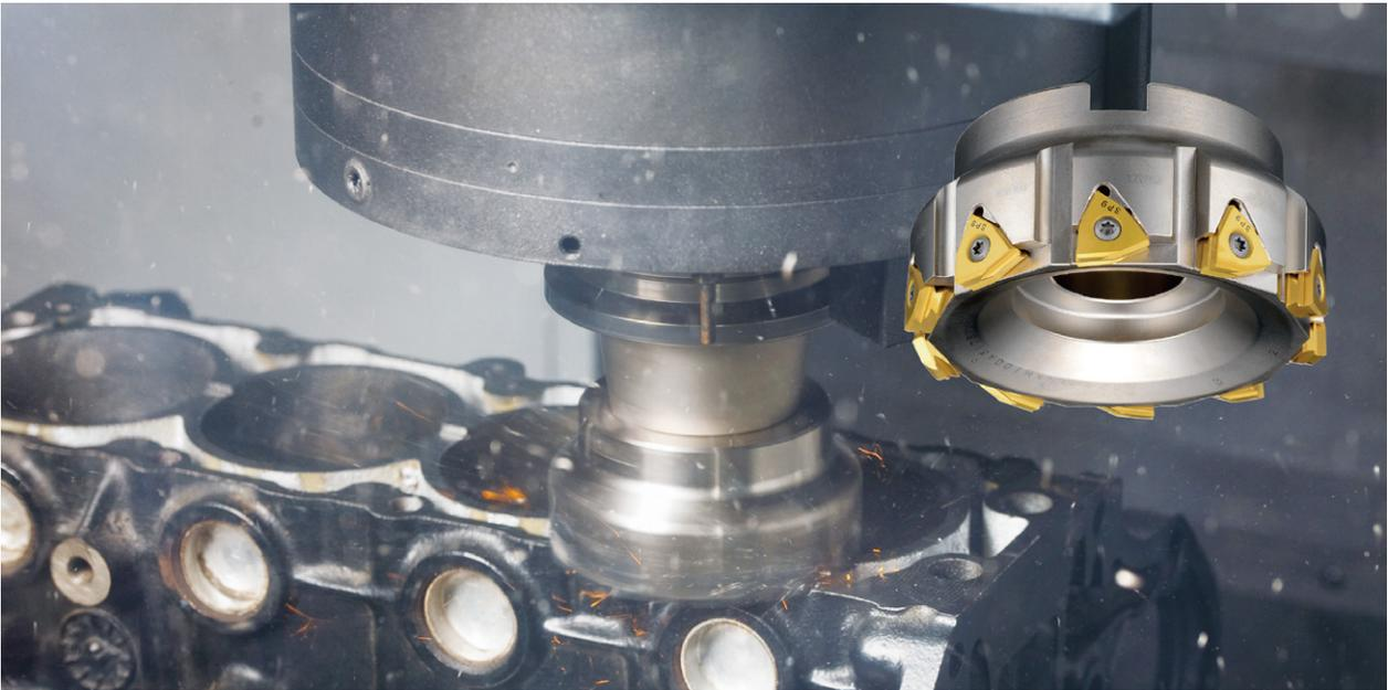
普通鋳鉄、ダクタイル鋳鉄加工用フライス工具 | セラミックインサート
