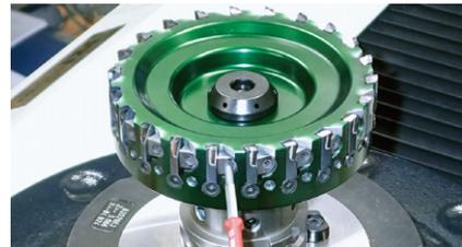
ウェッジ固定ネジを4N・mで締める。（時計回り）
