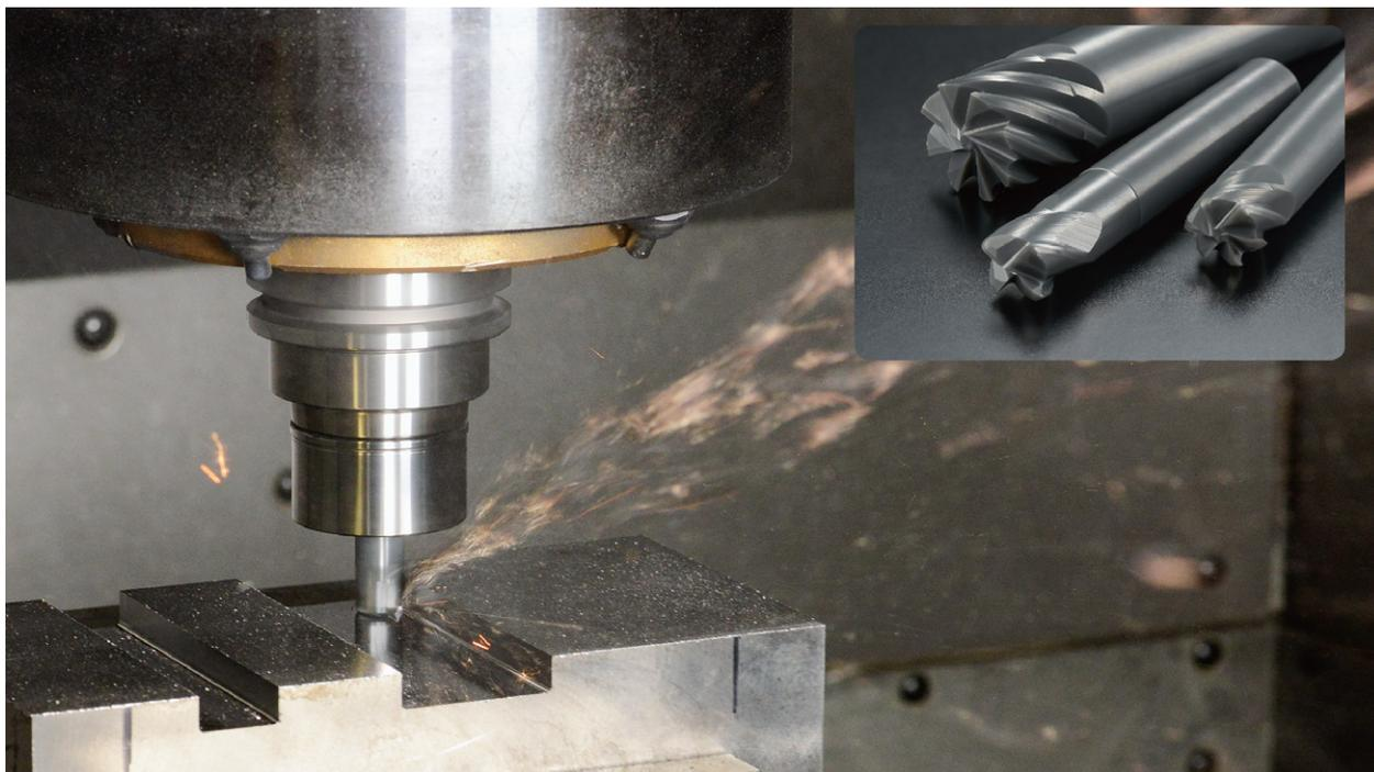
鋳鉄加工用 | セラミックエンドミル 刃先強化型
