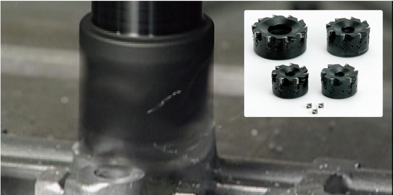
アルミニウム合金仕上げ加工用フライス工具 | PCDインサート
