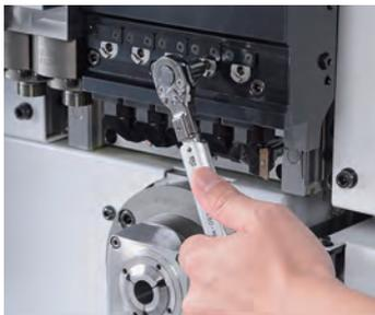
独自のカップリング構造により、ツールの着脱時はレンチを半回転締め込むだけの、クイックツールチェンジを実現。交換時間を約 80%短縮し、確実なツール交換が可能です。
