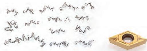
$v_c=70\text{m/min}$   $f=0.07\text{mm/rev}$   $a_p=1.0\text{mm}$
