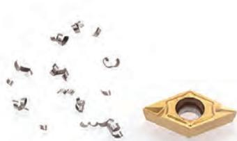
$v_c=70\text{m/min}$   $f=0.05\text{mm/rev}$   $a_p=1.0\text{mm}$
