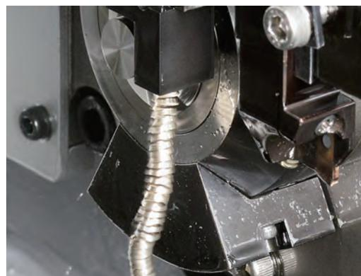
切屑を下方向に確実に落下させます
