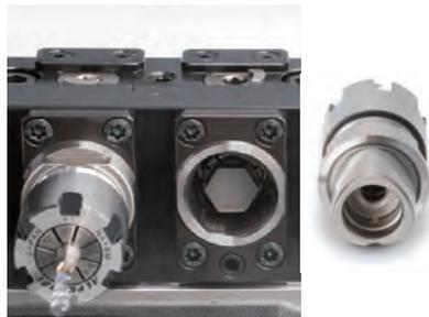
ポリゴンテーパシャンクを採用した2面拘束クランプユニットは、強じんなクランプ力を発揮。着脱時は径、芯、長手方向において $\pm 2\mu\text{m}$ の高い繰り返し精度を実現します。
