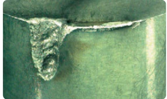
切込み量を一定にして、上図のように繰り返して粗加工を行うと、境界摩耗が短時間の内に進行するので、刃具寿命が著しく短くなります。境界摩耗を抑制して、刃具寿命を長くするには、次の2つの加工方法が効果的です。
