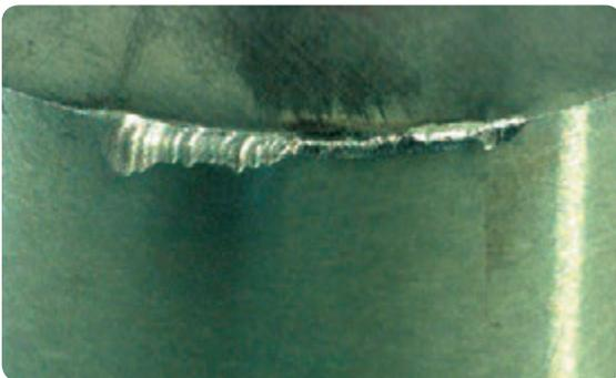
切込み量を変化させながら粗加工を行うと、境界摩耗が発生するポイントが毎回変わるので、境界摩耗が減少されます。
