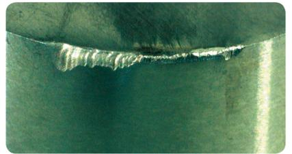
切込み量を変化させながら粗加工を行うと、境界摩耗が発生するポイントが毎回変わるので、境界摩耗が減少されます。
