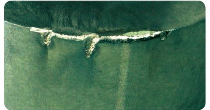
ランピング加工は、切込み量が連続的に変化するので、摩耗が切れ刃の全体に分散されます。
