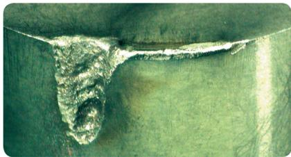
切込み量を一定にして、上図のように繰り返して粗加工を行うと、境界摩耗が短時間の内に進行するので、刃具寿命が著しく短くなります。
