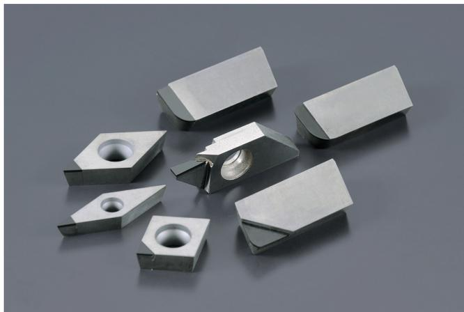
ダイヤモンドは非鉄材料との親和性が低いいため、耐溶着性に優れ硬度も最も高く、耐摩耗性に優れている反面、工具としての使用では強度が低く耐欠損性能に問題がありました
