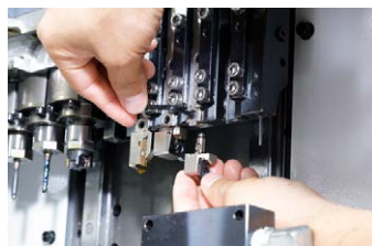
② 无需完全拧下螺丝，即可取下头部。
