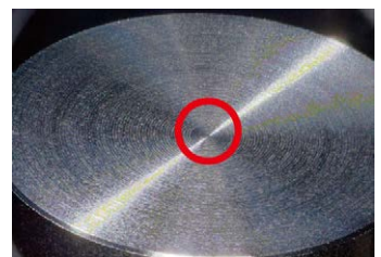
④ 再次加工端面，完成中心高调整
